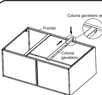
5.1 Encaixe a coluna gaveteiro no frontal, deixando-a levemente inclinada.
