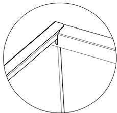
4º Encaixe o Frontal nas laterais para fechar o corpo, fixe com parafuso M4x6mm e porca M4.
